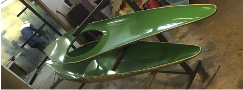
Figura 3.1. Molde de k1 Slalom casco y puente
